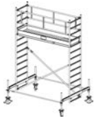
Wys. robocza: 4,40 m Wys. rusztowania: 3,40 m Wys. pomostu: 2,40 m
